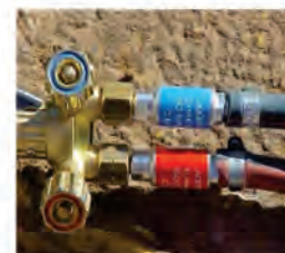
DETALLE A DOBLE VÁLVULA ANTIRRETORNO
