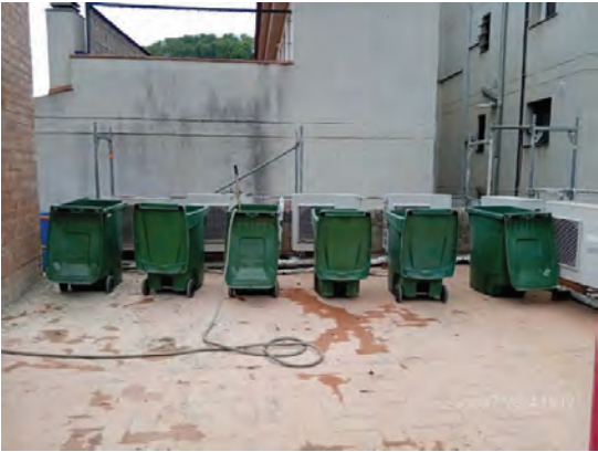
Foto 2: Disposició de càrrega en prova de sostre de coberta.
